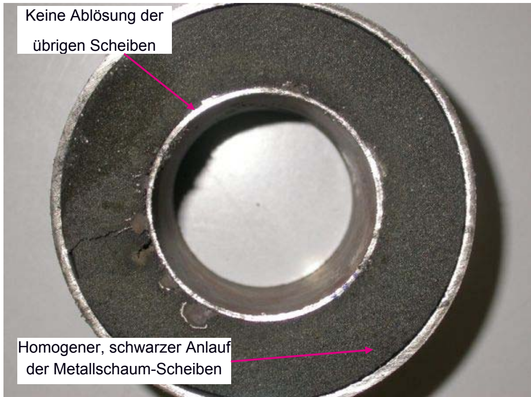
Abbildung 56: Letzte Metallschaumscheibe des zerlegten Reaktors
