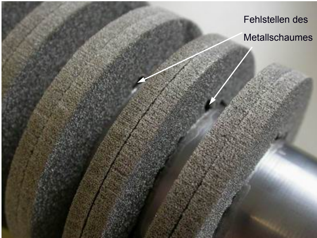
Abbildung 47: Fehlstellen des Metallschaumes nach dem Löten
