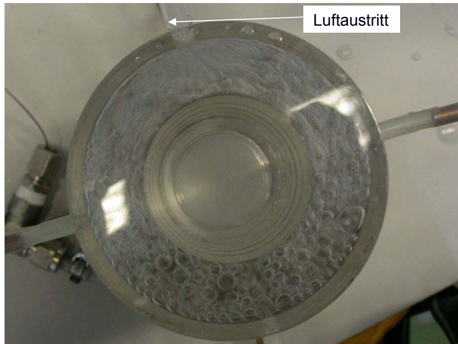
Abbildung 60: Luftblasen-Aktivität nach dem Sammelsystem des Reaktor-Modells
