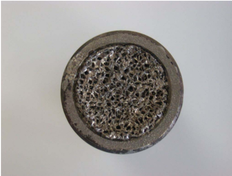
Abbildung 38: Metallschaum NC 2733 verlötet mit dem Rohr ( \phi=12 mm; Werkst. Nr. 1.4959)
