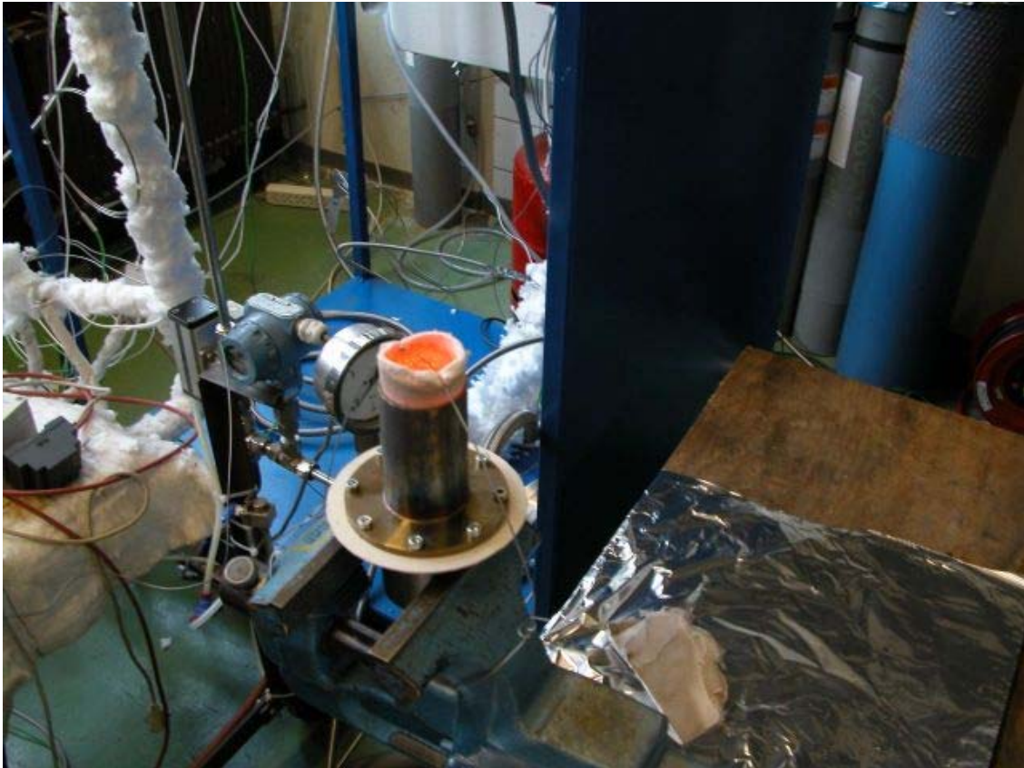
Abbildung 66: Test des Porenbrenners mit modifizierter Gasverteilung
