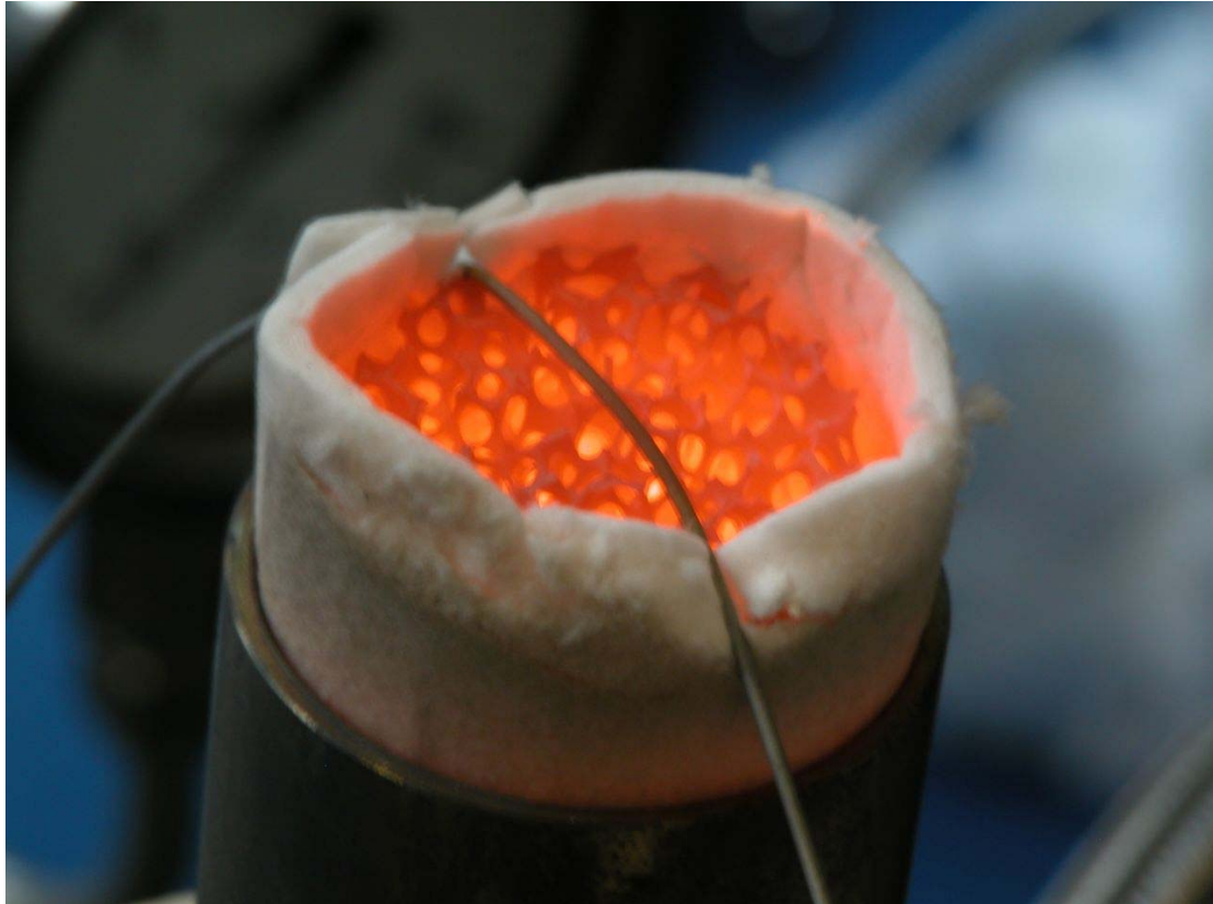
Abbildung 67: Nahaufnahme des Porenkörpers im Betrieb
