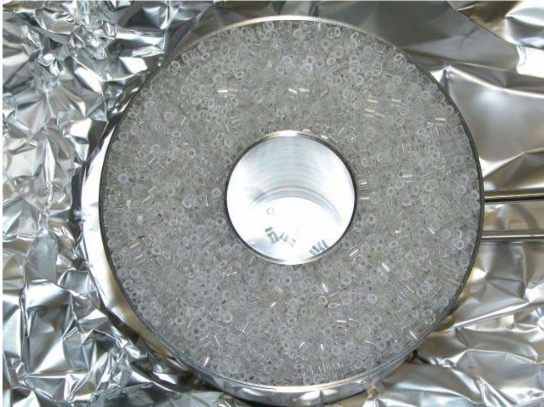
Abbildung 65: Raschig-Ring-Schüttung vor der ersten Metallschaum-Scheibe
