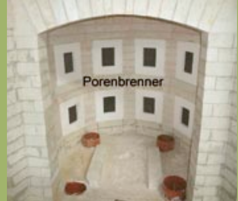
Links: Porenbrenner in Betrieb. Rechts: Innenansicht des Hafenoßens mit Porenbrennern.
